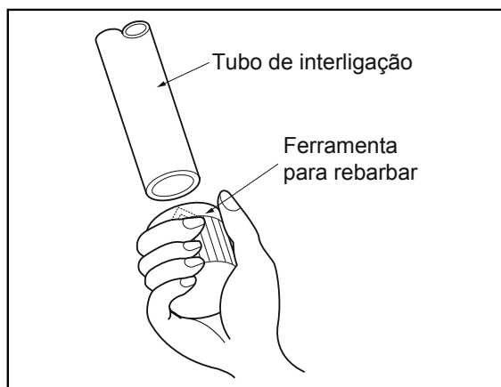
FIG. 21 - FERRAMENTA PARA REBARBAR
